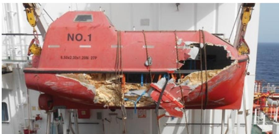
图中船舶的救生艇被另一艘操纵系靠的油轮的左侧首舷碰撞，遭受严重损坏
