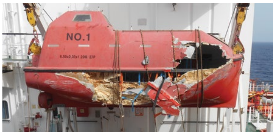
图中船舶的救生艇被另一艘操纵系靠的油轮的左舷首舷碰撞，遭受严重损坏
