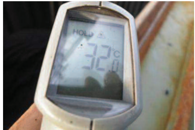
使用红外线温度计监测煤炭温度。
