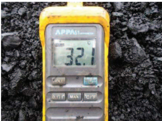
使用温度探针检测煤炭温度。
