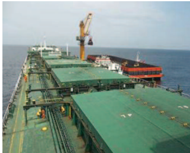
使用浮吊从驳船上吊装煤炭货物
