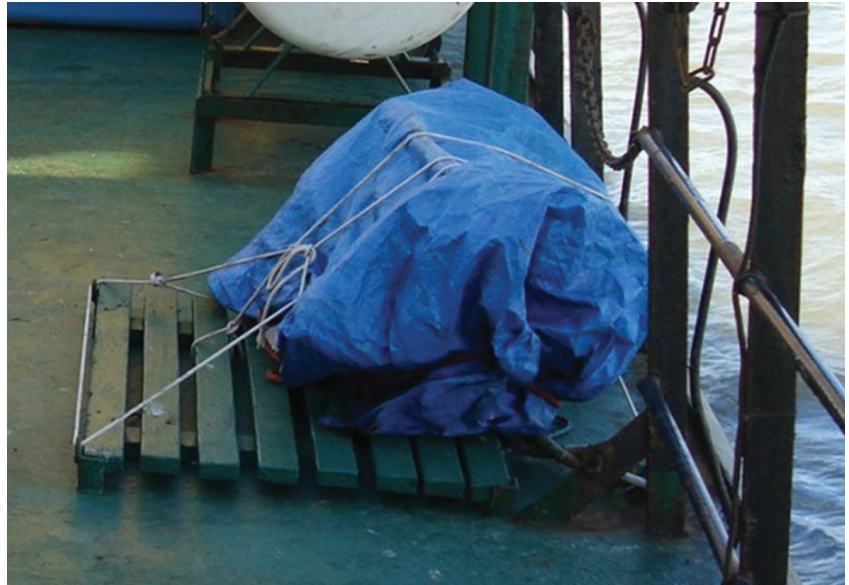
Một thang lên tàu được để cách xa sàn tàu và được che đậy một cách phù hợp
