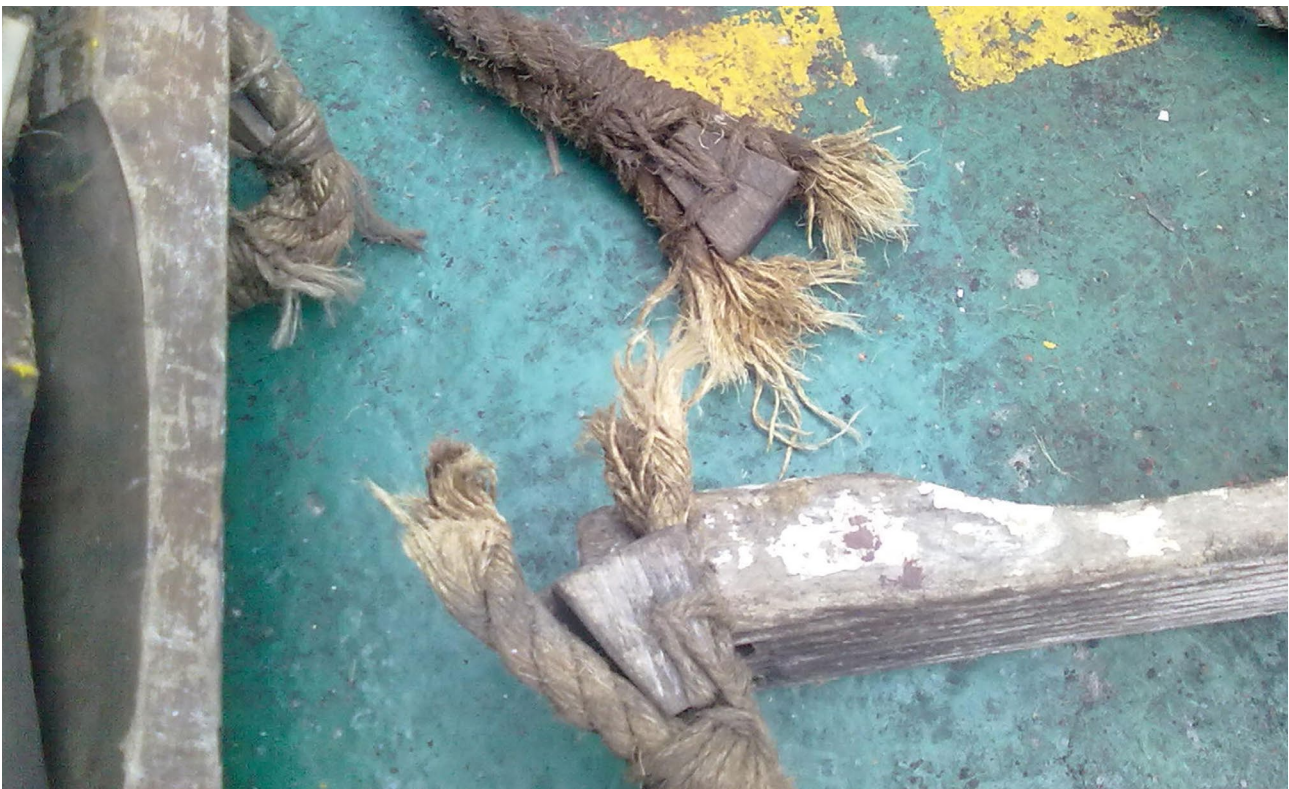
Một bên thang dây hoa tiêu bị đứt khi một hoa tiêu trèo trên thang
