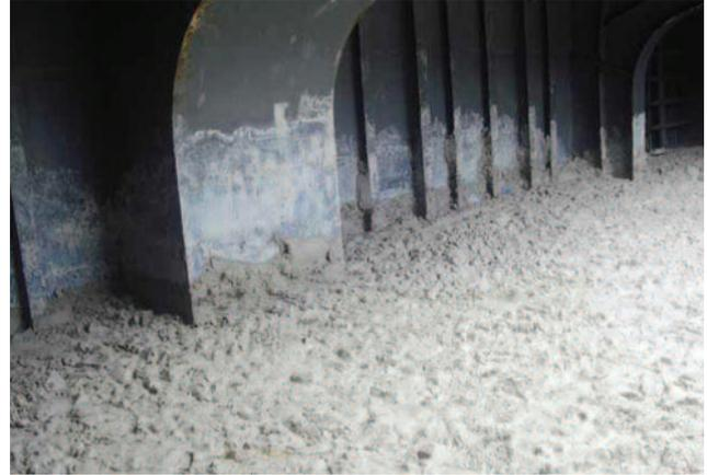
货舱钢板上货物的残留痕迹显示出了货物的移动程度
