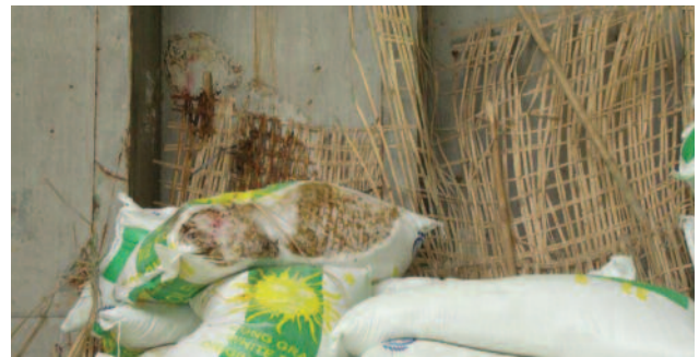
袋装米与船壳钢板接触而引致汗湿之货损
