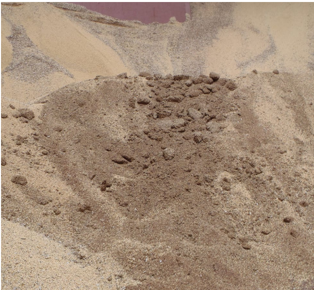
Hàng hóa vón cục do cạnh vách ngăn kết nhiên liệu bị nóng lên
