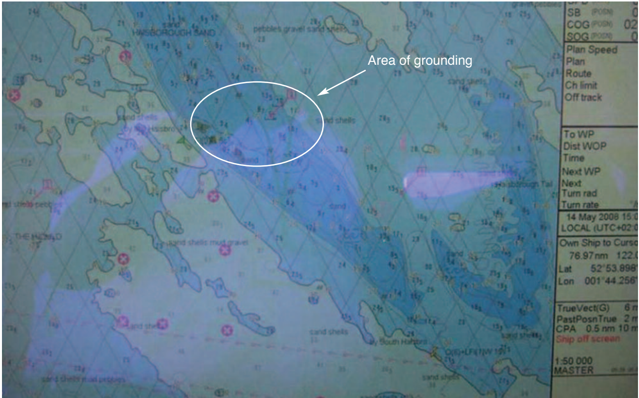
一艘 4,000 GT 杂货船, 在航程计划中使用 1:50,000 之海图, 可以看到在船搁浅出事的地方, 有更多详情
